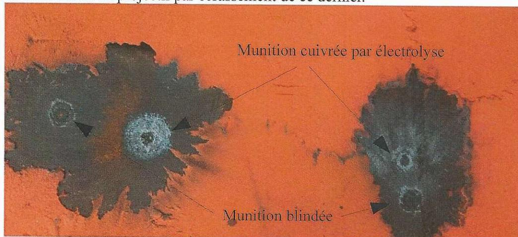
Il en résulte un résidu d'impact de couleur gris clair du fait des résidus de plombs issus de l'écrasement des munitions cuivrées, aucune marque pour les munitions blindées. La plaque ne présente, sur aucun des points d'impact de déformation perceptible.
